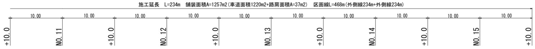
表層工5cm, 上層路盤10cm, 下層路盤10cm L=170m 舗装面積938.76m<sup>2</sup>
